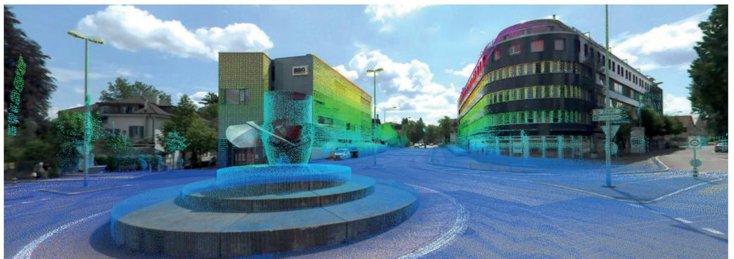
Bei der Messung entstehen dreidimensionale 360-Grad-Abbildungen des kompletten Straßenraums. Diese sind die Grundlage für digitale Geländemodelle.
